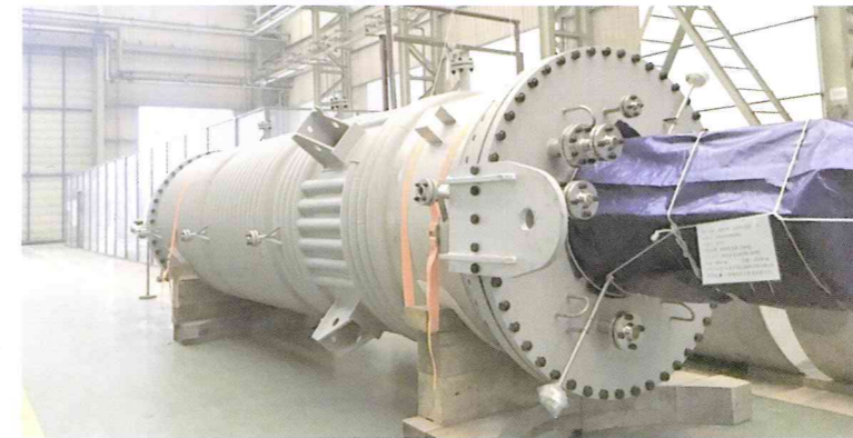
薄膜蒸发器18m 2 适用：甲基丙烯酸甲酯项目 材质：S31603 外形尺寸(长X宽X高) 1020X195X190cm
